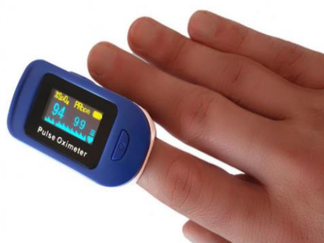
Figura 2.5. Pulsoximetru RedLine FS20C (Albastru/Alb, Indica nivelul de saturație a oxigenului din sânge, Măsoară rata pulsului, 4 poziții de citire a textului)
